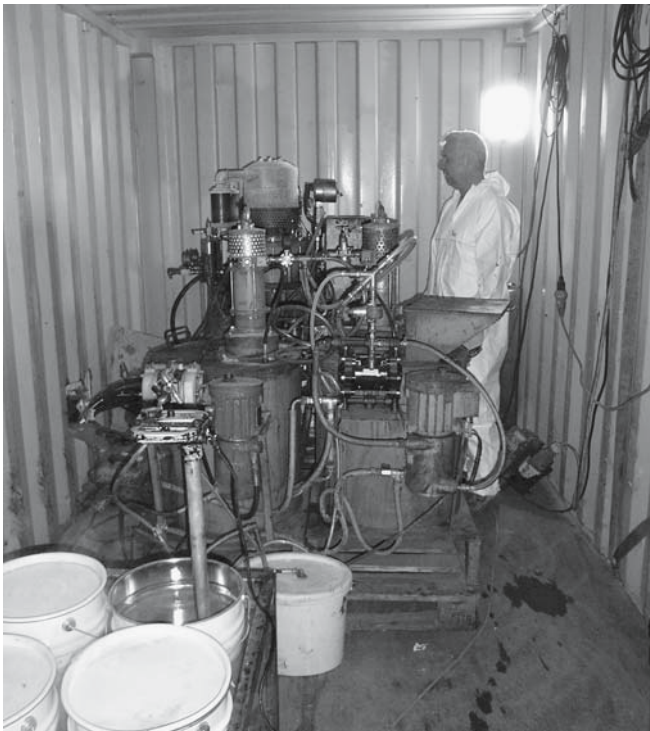
Das Harz wird mit einer speziellen Zweikomponenten-Anlage im Heißspritzverfahren in einer Schicht appliziert, die mindestens 1000 µm dick ist. Das 80 bis 90°C heiße Material wird bei einem Druck von 350 bis 400 bar aufgetragen.
