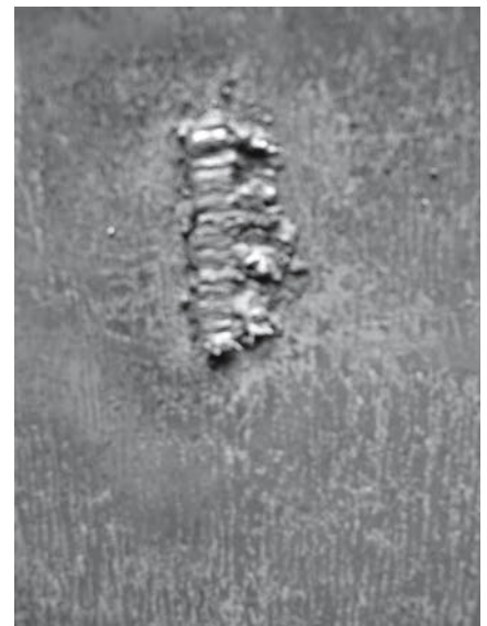
Die Ausführung der Tanks ließ zu wünschen übrig: Auf den Blechen fanden sich Dopplungen, Poren, Walzfehler und metallische Verunreinigungen. Zudem entsprachen die Schweißnähte nicht dem Qualitätsstandard für Beschichtungen.
