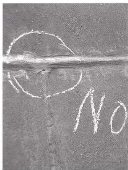
Die Ausführung der Tanks ließ zu wünschen übrig: Auf den Blechen fanden sich Dopplungen, Poren, Walzfehler und metallische Verunreinigungen. Zudem entsprachen die Schweißnähte nicht dem Qualitätsstandard für Beschichtungen.
