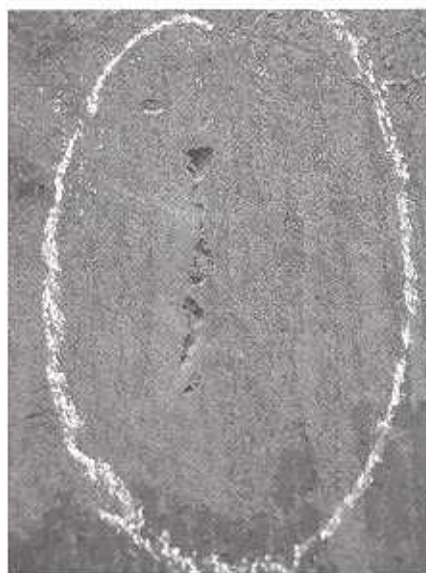
Die Ausführung der Tanks ließ zu wünschen übrig: Auf den Blechen fanden sich Dopplungen, Poren, Walzfehler und metallische Verunreinigungen. Zudem entsprachen die Schweißnähte nicht dem Qualitätsstandard für Beschichtungen.
