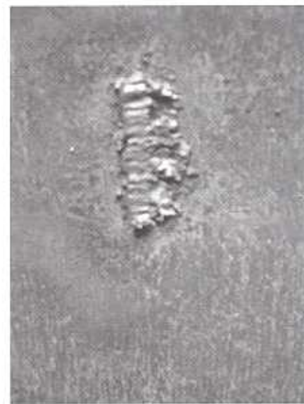
Die Ausführung der Tanks ließ zu wünschen übrig: Auf den Blechen fanden sich Dopplungen, Poren, Walzfehler und metallische Verunreinigungen. Zudem entsprachen die Schweißnähte nicht dem Qualitätsstandard für Beschichtungen.
